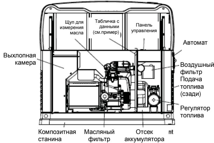
**Рисунок 1.3 – 12, 14, 16, 17 и 20кВт, двухцилиндровый V-образный двигатель GT-990/GT-999 (со съемной дверцей)**
