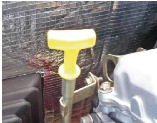
Рисунок 4.3 — Масляный щуп и заполнение, модели 12, 14, 16, 17 и 20кВт
