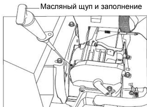
Рисунок 4.2 — Масляный щуп, модель 10кВт
