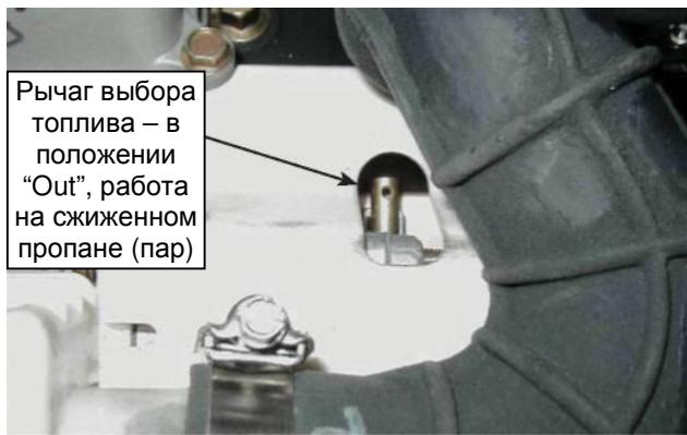
**Рисунок 1.7 – 12, 14, 16, 17 и 20кВт, GT-990/GT-999 (Снята крышка воздушной камеры)**
